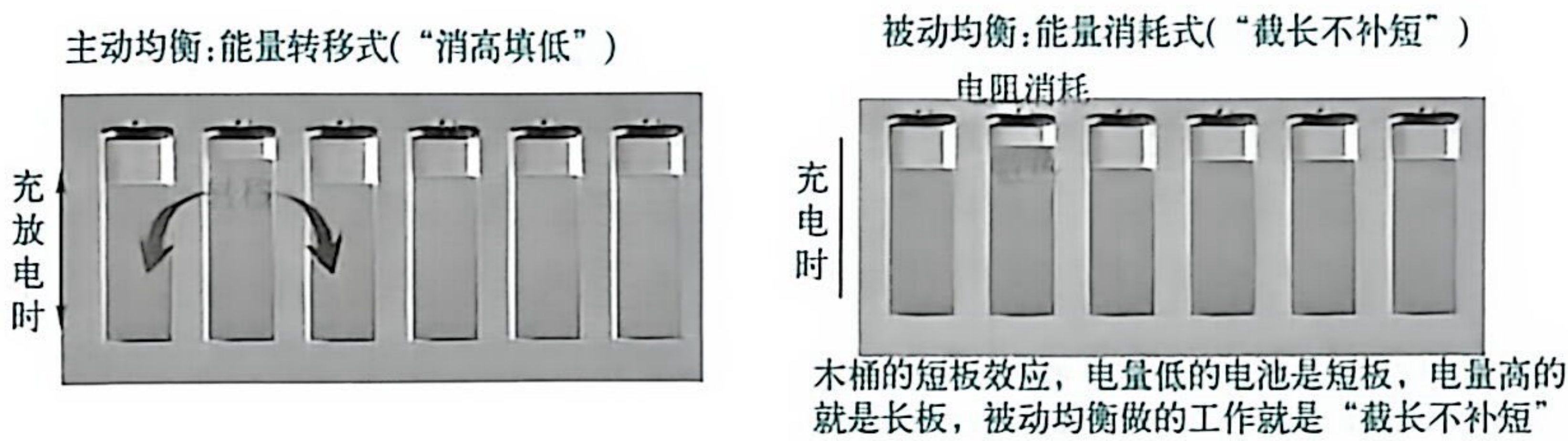
图6-2 主动均衡与被动均衡示意
