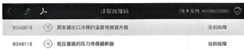
图 5-75 空调控制器故障码信息
