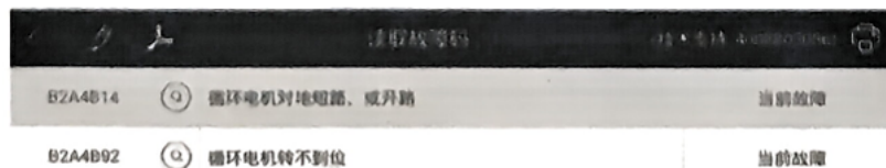
图 5-82 空调控制器故障码信息
